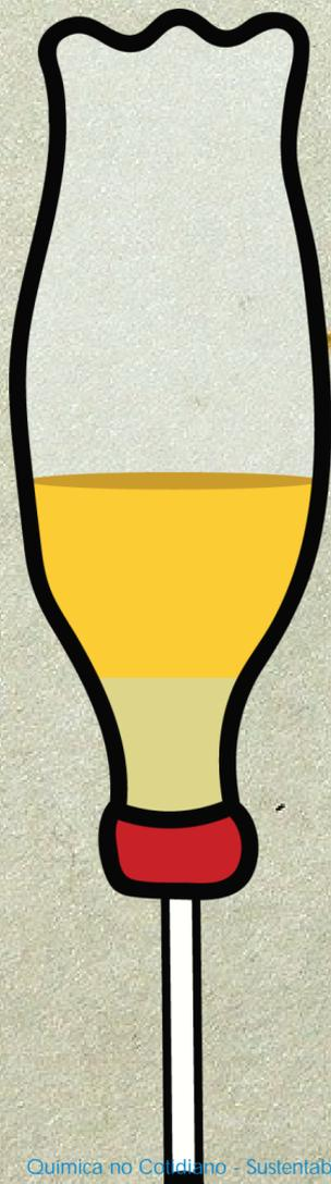
Para essa etapa, você precisará fazer um furo na tampa da garrafa PET e encaixar o canudo nesse furo, como na imagem ao lado. Sele bem com fita adesiva para que não tenha vazamento. Coloque a mistura dentro da garrafa pet e deixe vazar pelo canudo somente o conteúdo mais denso (aquele que ficou embaixo). Por fim, quando sair toda essa mistura do fundo, use seus dedos ou uma presilha para fechar o canudo.
